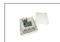
B71/PBX24/BOX/115 Inverter híbrido versión "Network Assisted" para la alimentación de la automatización, con función de carga de baterías a través de la conexión a los paneles solares o red fija, para alimentar los controladores digitales de 24V DC con tensión de red de 115V AC.
